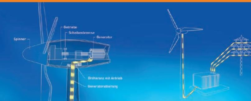
Eine Windkraftanlage – drehbar, auf standsicherem Turm – besteht im Wesentlichen aus einem Rotor mit Nabe und Rotorblättern sowie einer Maschinengondel, die den Generator und häufig ein Getriebe beherbergt. Die Rotorblätter entnehmen die Windenergie aus der Luft und führen diese dem Generator zu.
