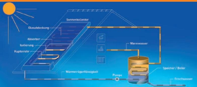
Der Absorber eines thermischen Kollektors wird durch die Sonnen-Energie erhitzt. Durch die Röhren des Kollektors strömt eine Flüssigkeit (seltener auch ein Gas), das diese Wärme aufnimmt. Mit einer Pumpe im Kreislauf wird das Wärmeträger-Medium dann zu einem Speicher (häufig ein Warmwasserspeicher) oder zum Verbraucher gepumpt.
