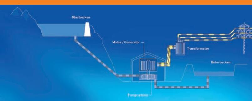
Ein Pumpspeicherkraftwerk ist ein Wasserkraftwerk, das aus einem unteren und einem oberen Staubecken besteht, die miteinander verbunden sind. Wenn überschüssiger Strom zur Verfügung steht, wird Wasser aus dem unteren in das obere Becken gepumpt. Bei hohem Strombedarf wird Wasser aus dem oberen Staubecken abgelassen.
